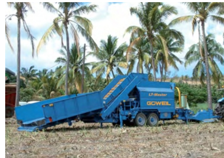
LT-Master ühendatud rullpress-kiletajaid kasutatakse üle kogu maailma.
