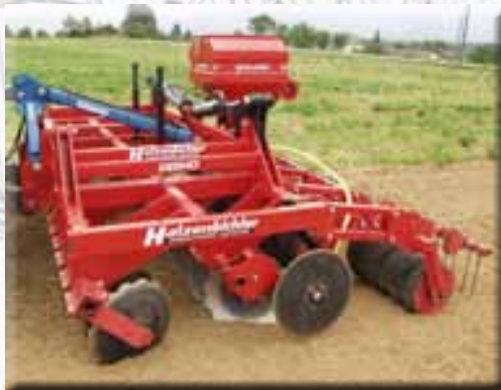
3m „Disko“ with pneum. Seeding machine „Air 8“
